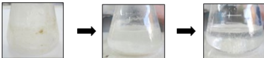
Figura 3. Desorción del aceite lubricante de la Ulexita con agua a 80°C constante
